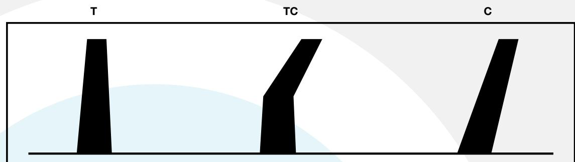
Les tasseaux en caoutchouc vulcanisés à chaud sont fabriqués dans notre atelier. Notre processus de fabrication unique nous permet de proposer un tasseau et une bande transporteuse parfaitement unisolidaires. Cette façon de travailler élimine presque totalement le risque de décollement du tasseau. Les tasseaux sont ainsi parfaitement adaptés aux applications les plus lourdes !
